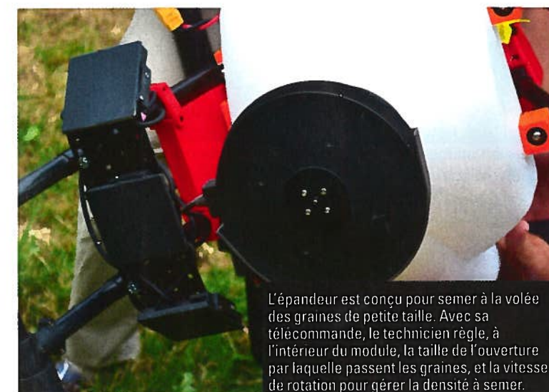
Le temps de chargement du module ne dure que 1 à 2 minutes. Un conteneur rempli de 10 kg de graines de semence couvre 1,25 hectare en 12 à 15 minutes.
